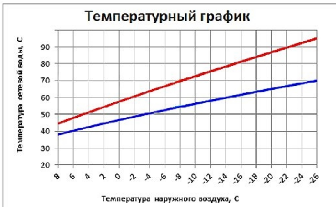
Рисунок 1.2 – Температурный график отпуска теплоносителя от источников теплоснабжения в зависимости от температуры наружного воздуха
